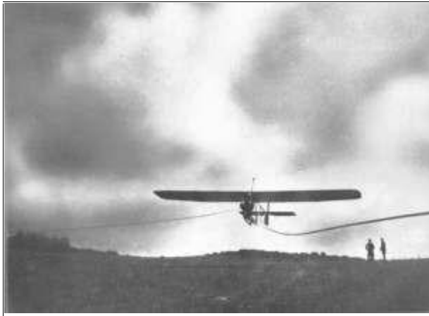
Gummiseilstart vom Feldherrenhügel - ein Zögling 33 wird mit dem Gummiseil in die Luft katapultiert. Etwa 1936.
